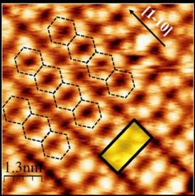
Silicène sur couche isolante de NaCl
