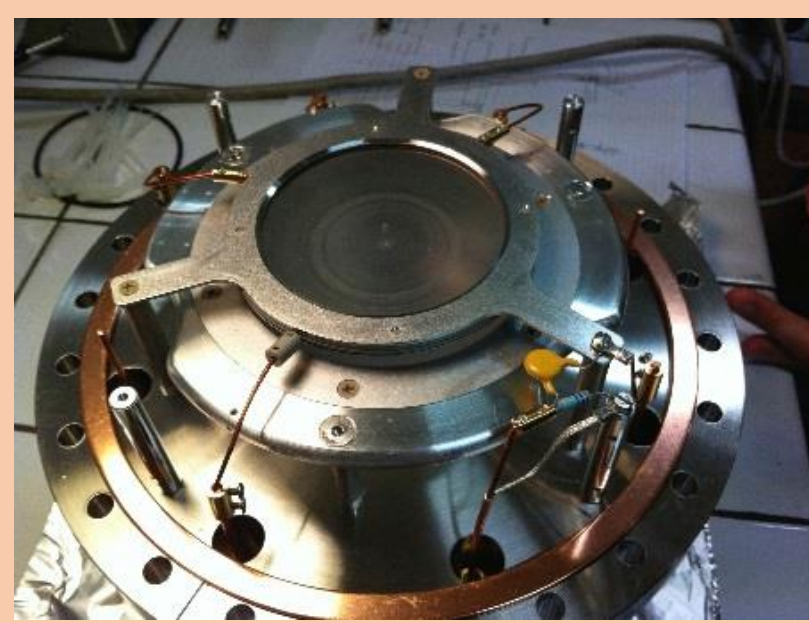
Détecteur électrons Multi-channel plate et écran phosphore
