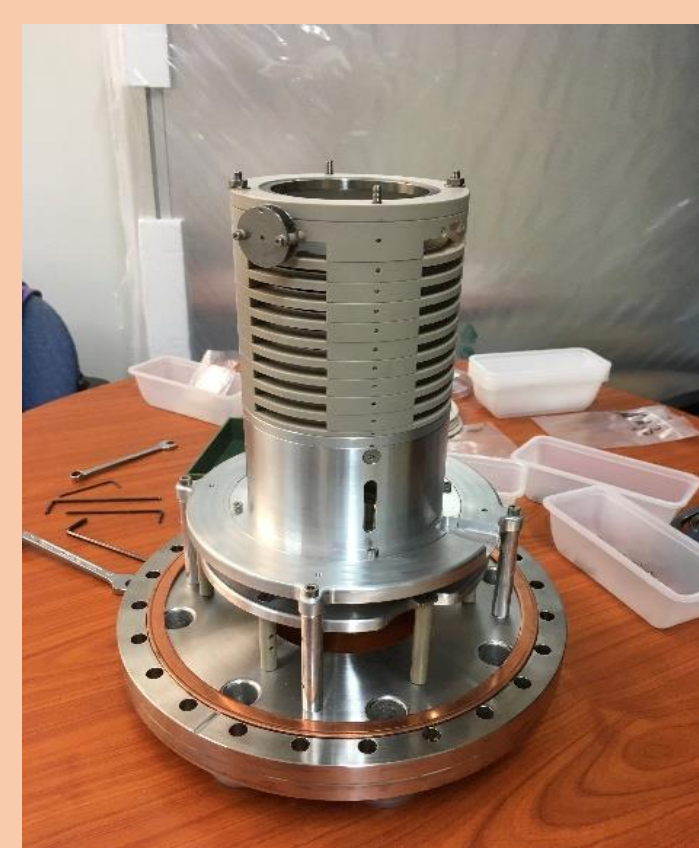
Nouveau spectromètre électrons de type VMI
